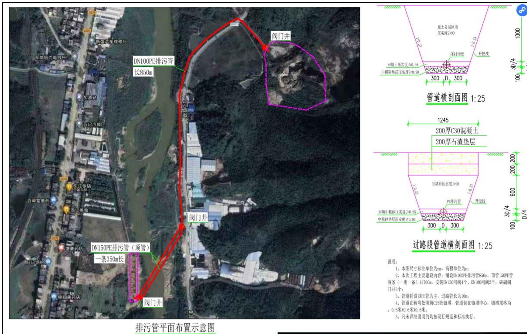
附图 12 项目外部排污管网布置图
